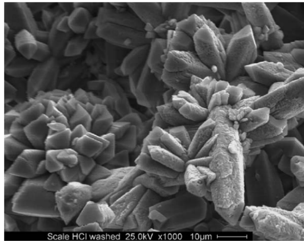
Gambar 2.14. Gambar Skala Kristalin Pada Permukaan Membran RO.
