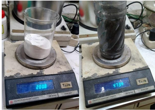
Gambar Proses Penimbangan bahan alumunium oksida dan abudasar batu bara
