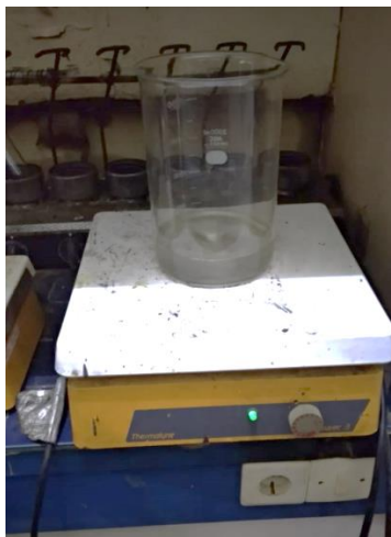
Gambar Proses pengadukkan bahan menggunakan magnetic stirrer
