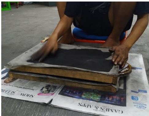
Gambar Proses Pengayakanabudasarbatubaradengan mess 350
