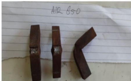
Gambar 5, hasil patahan ulet pada spesimen hardening 850 0 pendingin air.
