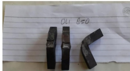
Gambar 7. hasil patahan ulet pada spesimen hardening 850 0 pendingin oli
