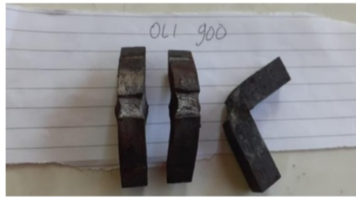
Gambar 6. hasil patahan ulet pada spesimen hardening 900 0 pendingin oli
