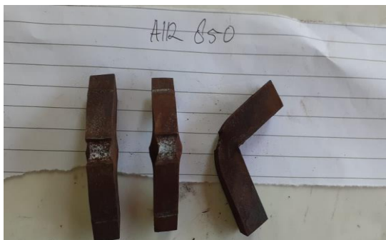
Gambar 5, hasil patahan ulet pada spesimen hardening 850° pendingin air.
