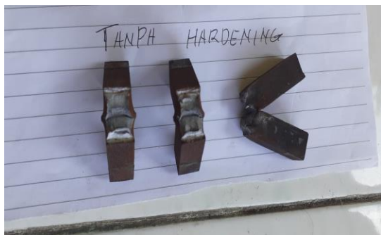
Gambar 4, hasil patahan getas pada spesimen tanpa perlakuan panas
