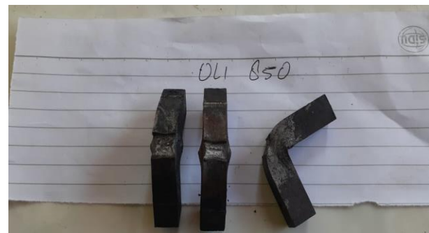
Gambar 7. hasil patahan ulet pada spesimen hardening 850° pendingin oli
