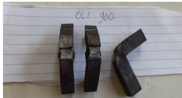
Gambar 6. hasil patahan ulet pada spesimen hardening 900° pendingin oli
