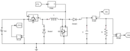
Gambar 4. Pemodelan *DC-DC Converter*
