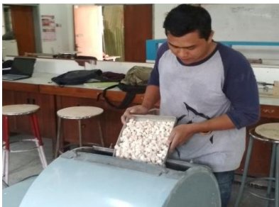
Keausan Agregat Kasar (Batu Kapur)
