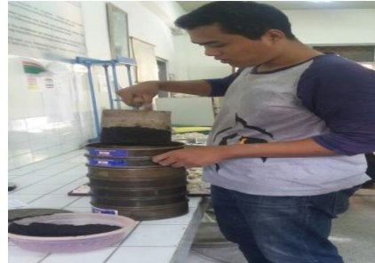
Analisa Saringan Agregat Halus
