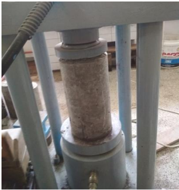
Proses Tes Tekan Benda Uji Beton
