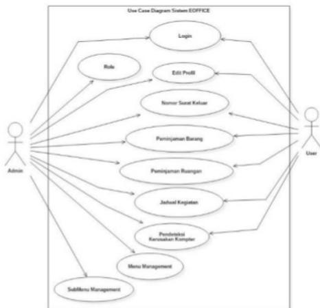
Gambar 1 Diagram Sistem *Use Case* sistem eoffice
