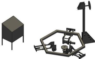
Gambar 3. Alat Panjat Pohon Kelapa Berikut adalah spesifikasi alat.
