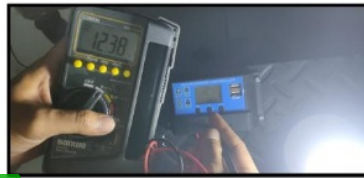
Gambar 4. 3 Pengukuran tegangan beban lampu
