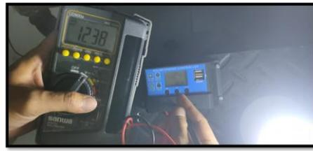
Gambar 4. 3 Pengukuran tegangan beban lampu
