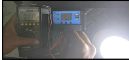
Gambar 4. 4 Pengukuran arus beban lampu
