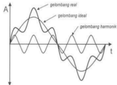
Gambar 2 Gelombang fundamental , harmonik ketiga dan hasil penjumlahannya.
