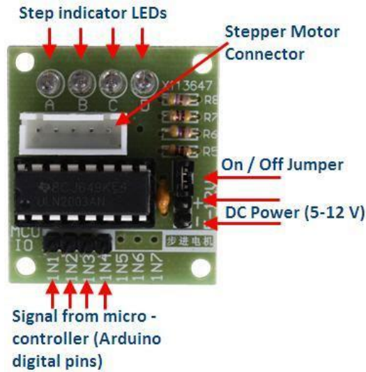
Gambar 2.18 Board Dengan IC ULN2003
