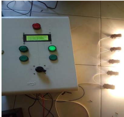
Gambar 20. Kontrol Switch Keadaan PLN ON
