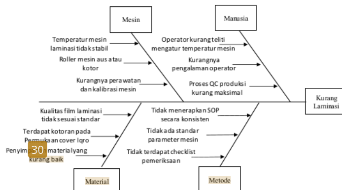
Gambar 3. 3 Diagram Fishbone Cacat Kurang laminasi (Sumber : Hasil Observasi)
