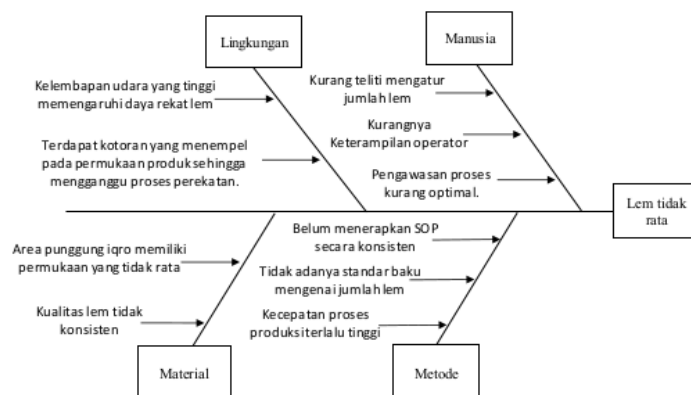
Gambar 3. 4 Diagram Fishbone Cacat Lem Tidak Rata (Sumber : Hasil Observasi)
