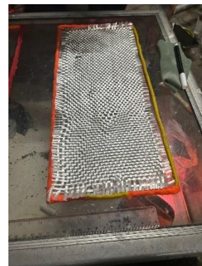
Penataan serat fiberglass ke dalam cetakan
