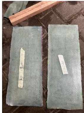
Komposit setelah dilakukan proses hand lay up
