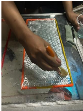
Pengolesan resin dan hardener pada komposit
