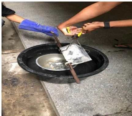
Proses quenching spesimen dengan media air
