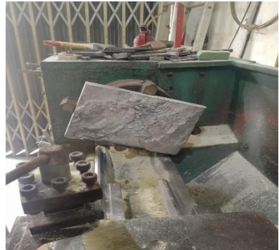
Proses bubut facing untuk meratakan permukaan
