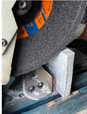
Pemotongan awal menggunakan gerinda duduk
