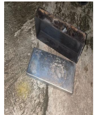
Membongkar hasil aluminium cair yang sudah membeku
