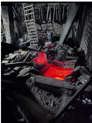
Mengambil aluminium cair pada tungku krusibel
