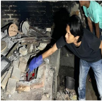
Memasukkan aluminium ke dalam tungku krusibel
