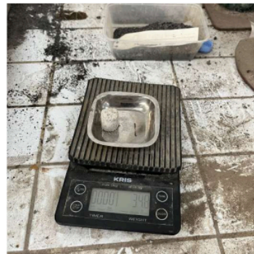
Gambar 2. Pengujian Kadar air setelah keluar dari oven
