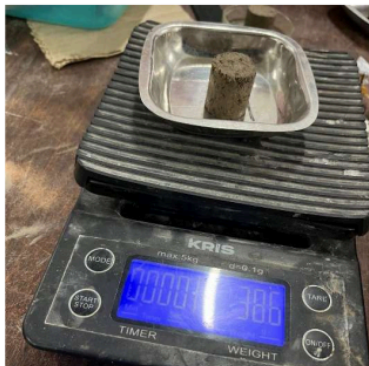
Gambar 1. Pengujian kadar air sebelum dimasukkan oven
