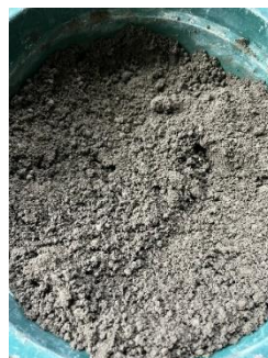
Gambar 3. Pencampuran Sampel Tanah Menggunakan Kapur dan Bakteri Bacillus Subtilis
