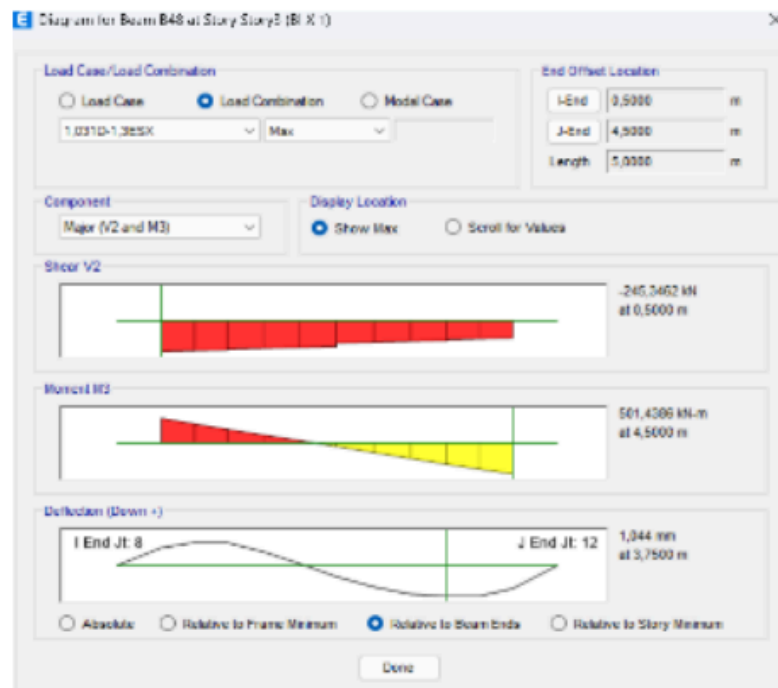
Gambar 4. 63 Output Momen dan Lendutan Balok Induk Arah X BI X 1 Gedung A pada Daerah Tumpuan Positif (Sumber : Data Olahan Peneliti, 2026)
