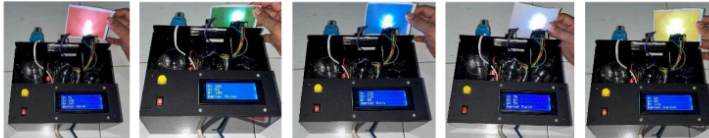
Gambar 4. Pengujian Sensor Warna a) Merah b) Hijau c) Biru d) Putih e) Kuning
