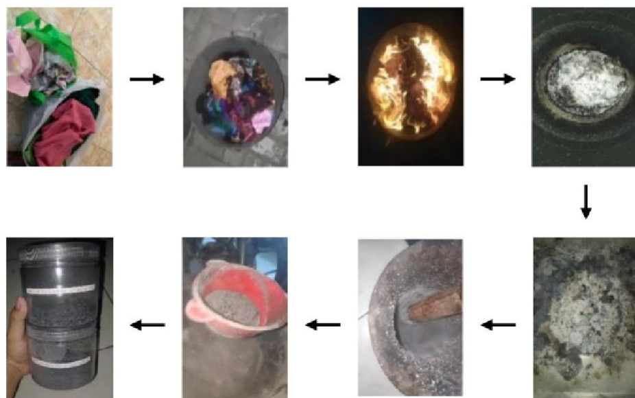
Gambar 3. 2 Proses Pengolahan Kain Katun Menjadi Filler (Sumber : Olahan Peneliti, 2026)
