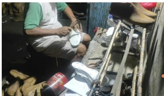
Lampiran 3 Pemasangan Sol
