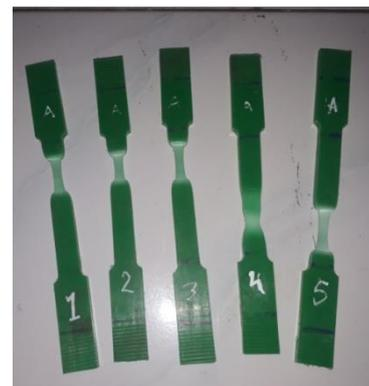
Gambar 18. Foto Spesimen Hasil Rancang Bangun Setelah Diuji
