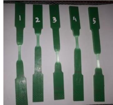
Gambar 17 Foto Spesimen Universitas Tertentu Setelah Diuji
