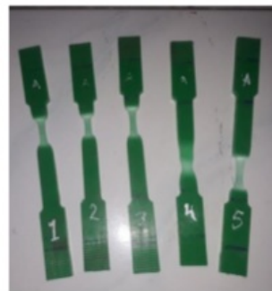
Gambar 18. Foto Spesimen Hasil Rancang Bangun Setelah Diuji
