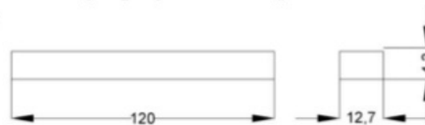
Gambar 19 Dimensi ASTM D790-07
