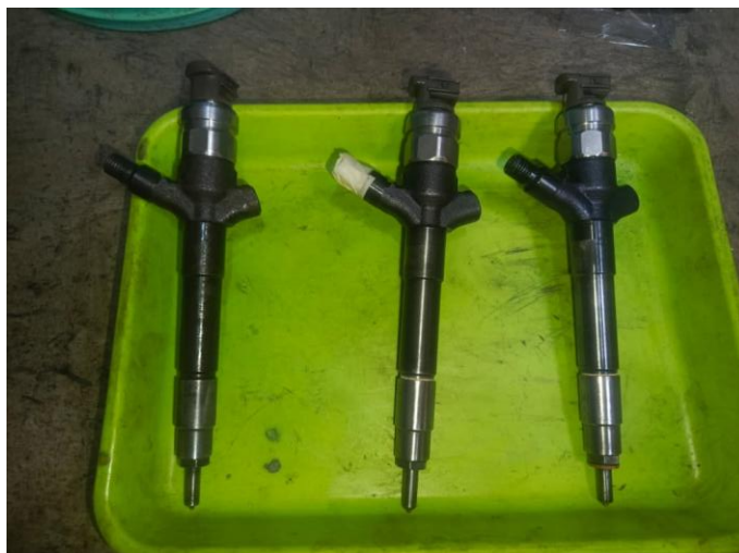
Variasi Nozzle Injektor 0.150, 0.152, 0.154 mm
