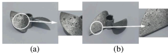
Gambar 3 (a) cacat porositas gelembung udara (b) Cacat Misrun
