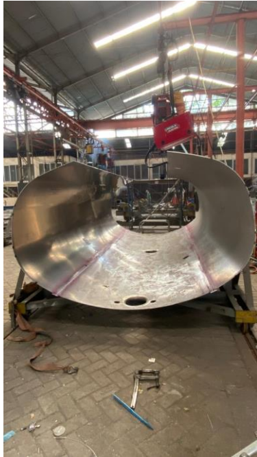
Lampiran. 11 Dokumentasi Proses Rolling Tangki BBM
