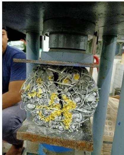
**Gambar 3 Uji Kuat Tarik Beton**
