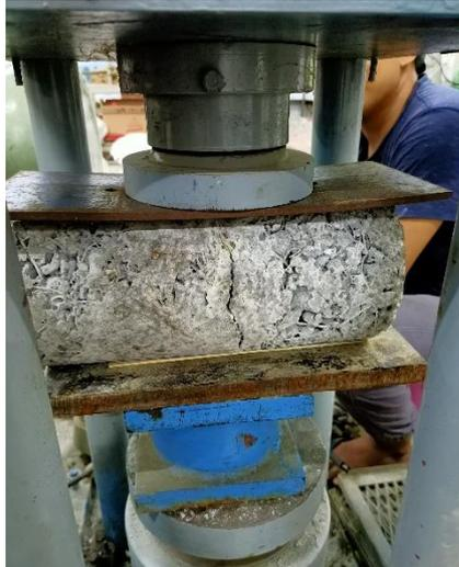
**Gambar 2 Uji Kuat Tarik Beton**
