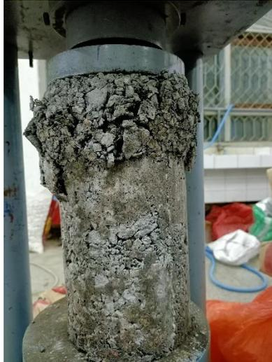
**Gambar 4** Uji Kekuatan Tekan Beton
