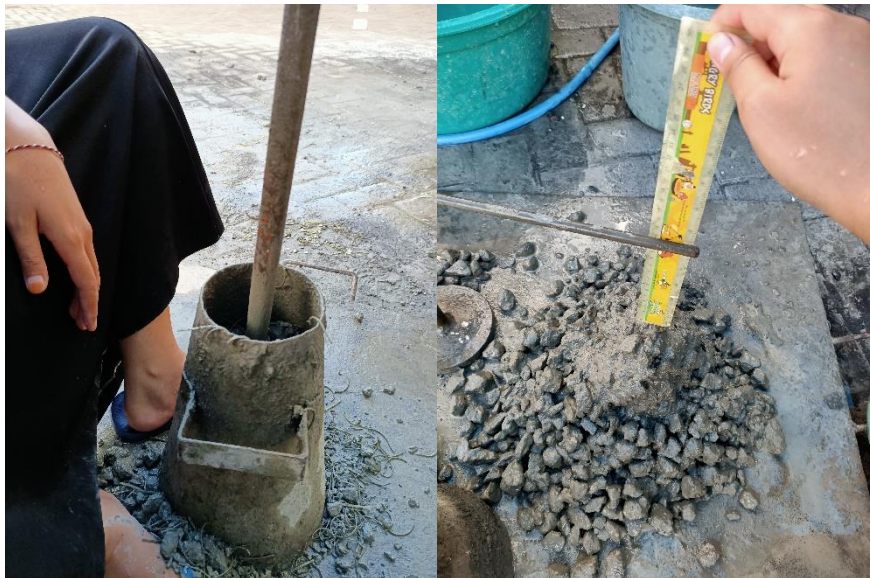
Merojok Adonan Beton
