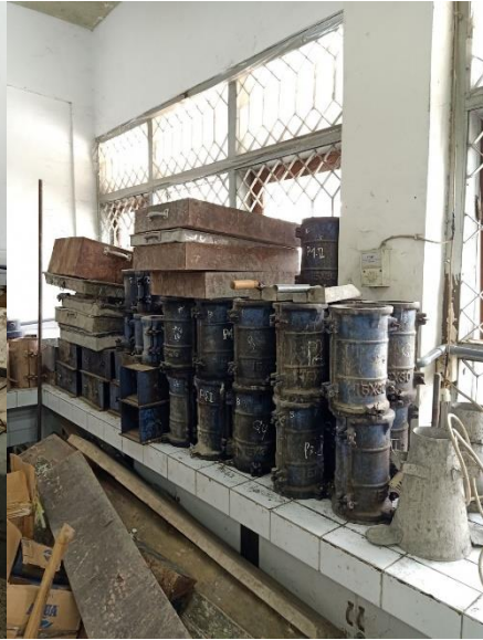
Cetakan Benda Uji (Silinder)
