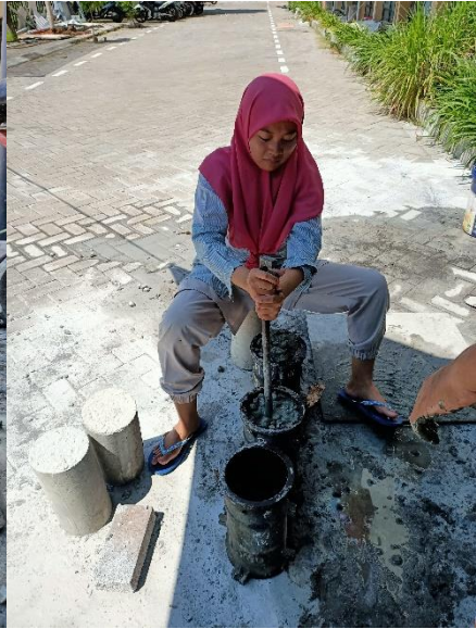
Merojok Adonan Beton Di Cetakan Silinder
