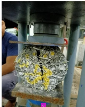
Gambar 3 Uji Kuat Tarik Beton
