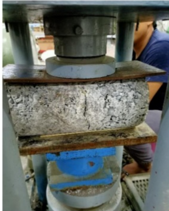
Gambar 2 Uji Kuat Tarik Beton
