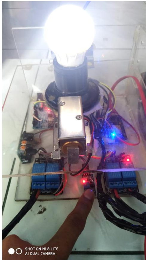
Gambar 4.18 Relay Lampu Menyala dalam Mode Otomatis
