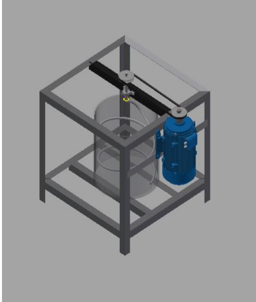
Gambar 3D Kerangka Pengaduk Adonan
