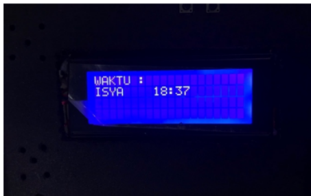
Gambar. 13 Uji RTC DS3231
