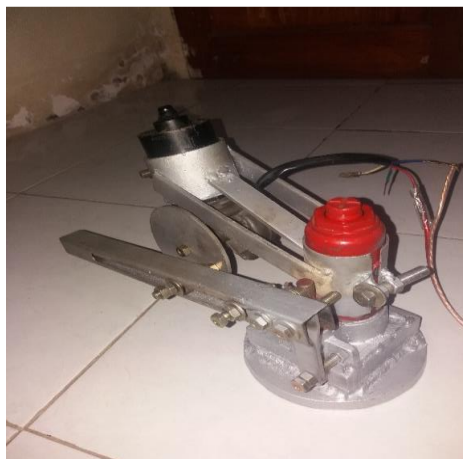
Gambar 9. Hasil akhir dongkrak hidrolik dengan bantalan luncur serta sistem elektriknya
