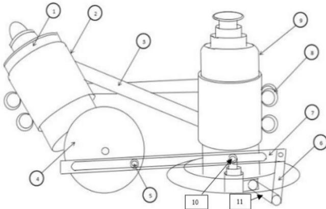
Gambar 1. Desain dongkrak hidrolik dengan bantalan luncur serta sistem elektriknya
