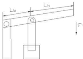
Gambar 8. Gaya tuas pada dongkrak hidrolik elektrik
