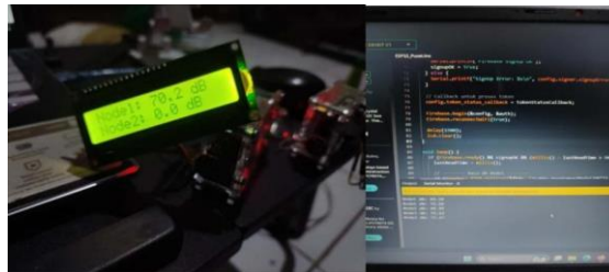
Gambar 3. Rancangan Alat Deteksi Kebisingan
