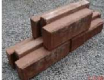
Gambar 2.3 penyusunan bata Interlock (Sumber : Budiayani & Prastyatama, 2020)
