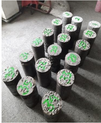
Hasil Benda Uji Saat Pelepasan Cetakan
