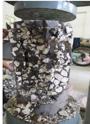
Hasil Kerusakan Beton Setelah Pengujian
