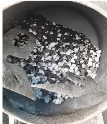
Proses pencampuran mix benda uji
