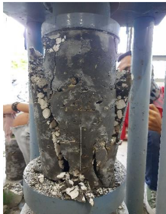
Proses Uji Kuat Tekan Beton
