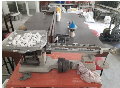
Proses Uji Hasil Resapan Batu Kapur
