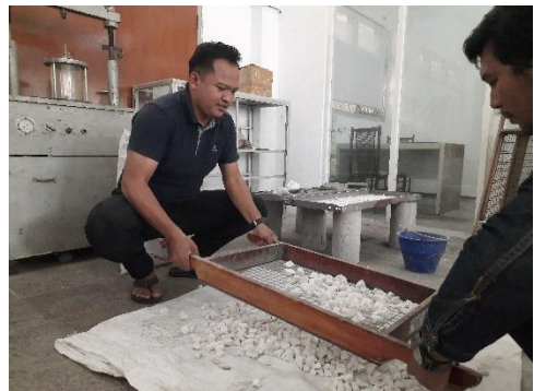
Proses Uji Analisa Saringan Batu Kapur
