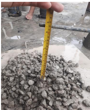
Proses Uji Tinggi Slump Beton
