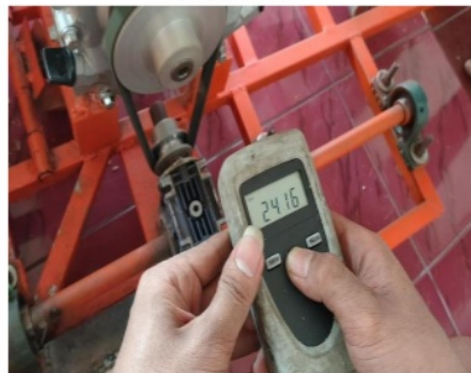
Proses Pengujian mesin pengemas gabah sederhana.
