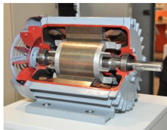
Gambar 1.9. Stator dan rotor motor universal
