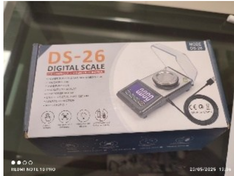
Gambar 4.1 Timbangan ( ketelitian 0,001 gram )
