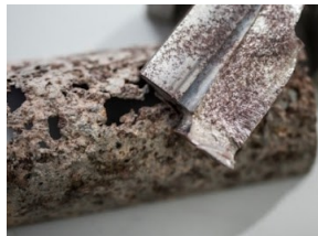
b) korosi lubang
