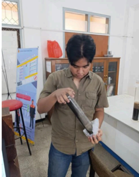
Gambar 12 Pengujian Agregat Halus (Kebersihan Lumpur)
