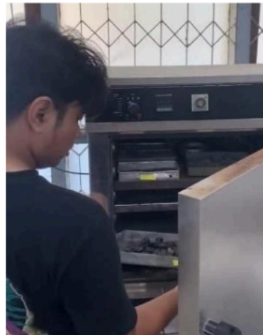
Gambar 3 Pengujian Agregat Kasar (Kelembapan Agregat)
