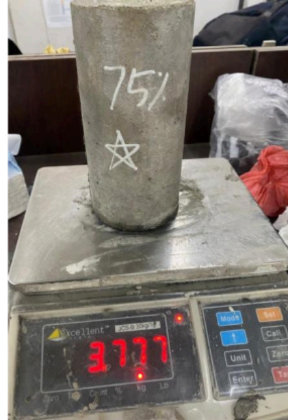
Gambar 17 Pengujian Resapan Air Beton
