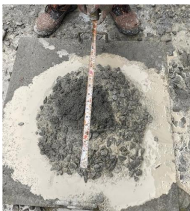
Gambar 4 Pengukuran panjang slump flow
