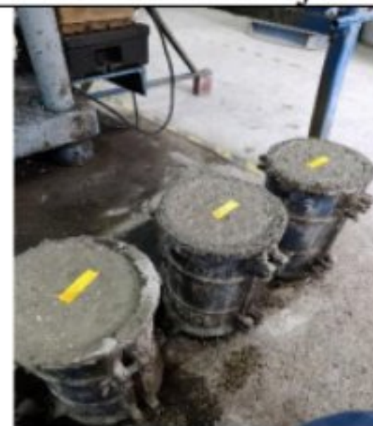
8. Diamkan beton sampai kering
