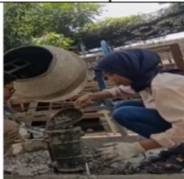
5. Beton segar siap dimasukan ke dalam cetakan
