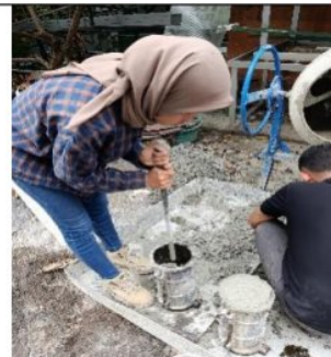
6. Beton dimasukan ke cetakan kemudian dirojok
