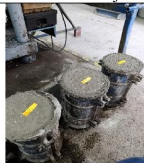
8. Diamkan beton sampai kering
