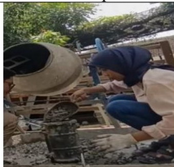
5. Beton segar siap dimasukan ke dalam cetakan
