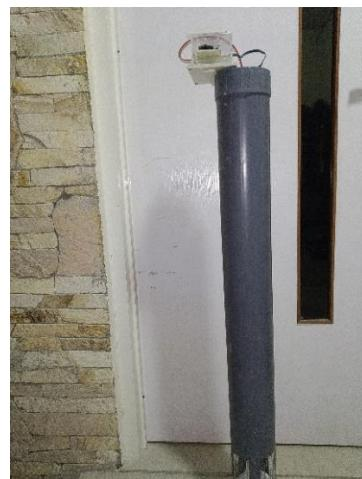
hasil dari desain prototipe alat sistem monitoring pendekksi dini banjir secara realtime berbasis website, pada bagian paling atas adalah box yang berisi rangkaian dan penutup pipa yang sudah didesain untuk bisa meletakan sensor dibagian tengah penutup pipa.
