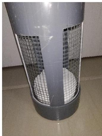
Filter penghalang kotoran masuk yang berfungsi untuk menghalangi sampah masuk dan tidak menyumbat aliran air masuk pipa, jaring pipa adalah kawat jaring yang berlubang untuk mempercepat air masuk dan keluar atau air naik dan air turun.
