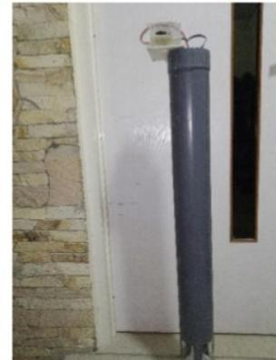
hasil dari desain prototipe alat sistem monitoring pendeksi dini banjir secara realtime berbasis website, pada bagian paling atas adalah box yang berisi rangkaian dan penutup pipa yang sudah didesain untuk bisa meletakan sensor dibagian tengah penutup pipa.
