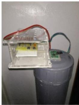
box yang berisi rangkaian dan penutup pipa yang didesain untuk bisa meletakan sensor ultrasonik US 015 beserta rangkaian kabel-kabelnya, penutup pipa bisa dilepas dan dipasang kembali untuk mempermudah penambahan diameter pipa yang diberikan sambungan pipa.
