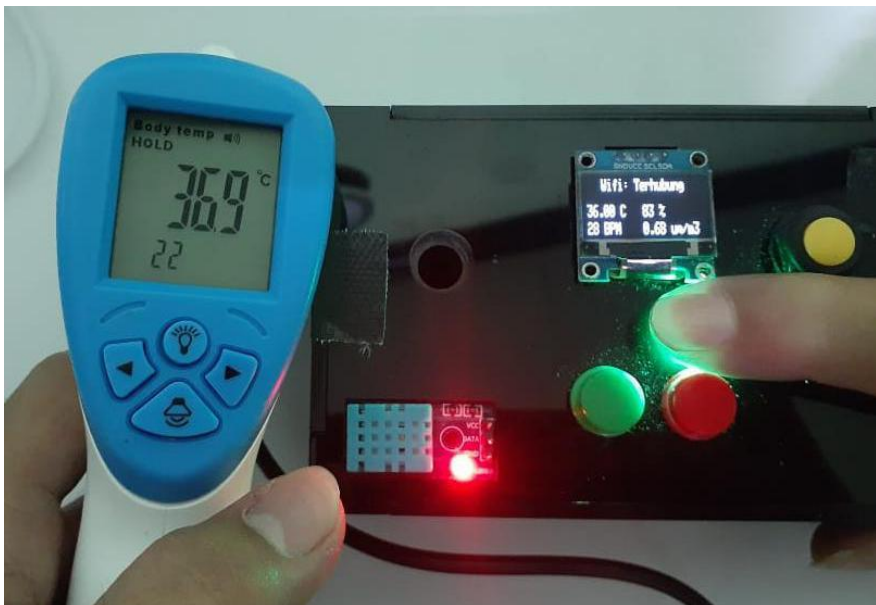
Gambar L1.2 Kalibrasi Alat dengan Thermometer Gun
